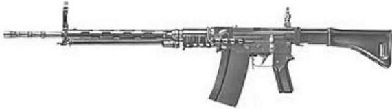
Modificando opportunamente il sistema di scatto si ottenne la possibilità di selezionare il tiro anche a raffica dotando l'arma di un serbatoio prismatico amovibile da 20 colpi; la canna venne accorciata e dotata di un tromboncino con funzioni di spegnifiamma, lanciagranate e compensatore di rinculo il tricompensatore, venne applicato un bipede il lega leggera e di calciolo
