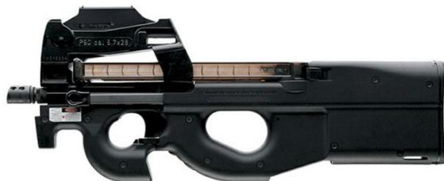
L'arma ha una lunghezza complessiva di 500 mm. con una canna di 263 mm., può sparare in modalità semiautomatica od a raffica i colpi contenuti in un caricatore semitrasparente della capacità di 50 cartucce con una velocità teorica di 900 colpi al minuto. Il selettore di tiro è incernierato direttamente al grilletto e tutti i comandi sono ambidestri, gli organi di mira sono costituiti da un collimatore ed un mirino laser integrato; la
