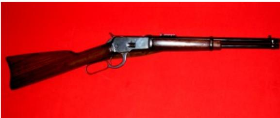
In queste armi il funzionamento è comandato da una leva che protegge il grilletto e che, azionata verso il basso, apre l'otturatore, arma il cane esterno il bossolo e posiziona una cartuccia, prelevata dal serbatoio tubolare sotto la canna, in linea con la camera di scoppio; riportando la leva in posizione di riposo, la cartuccia viene camerata dalla chiusura dell'otturatore che, a sua volta, viene bloccato dallo scorrimento verticale di un robusto blocchetto di fermo.
