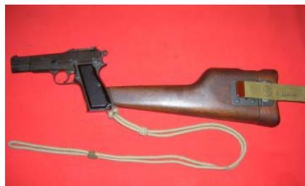
In Belgio la FN produsse la prima pistola di concezione moderna, la HP 35, con caricatore bifilare della capacità di 13 cartucce calibro 9; tale arma, potente e precisa venne prodotta in diverse versioni, tra cui una con calcio in legno, e venne adottata da diversi Paesi tra cui l'Inghilterra che la mantenne in servizio fino agli anni novanta del secolo scorso.
